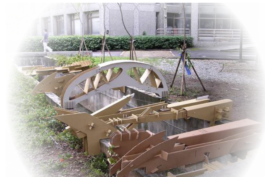
[2] 大一設計「橋」，以瓦楞紙板卡接方式(不能用黏的)組合出可以承受一定重量的橋。
